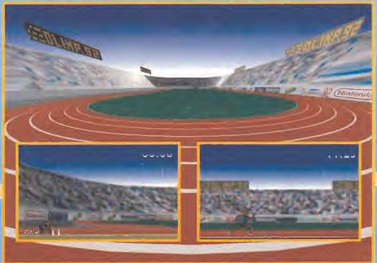
Topo ha usado una técnica bastante curiosa para generar los gráficos del estadio en el que transcurren sus olimpiadas. En lugar de crear los fondos cuando el atleta pasa frente a ellos, el ordenador guarda en memoria la imagen completa del circuito.
